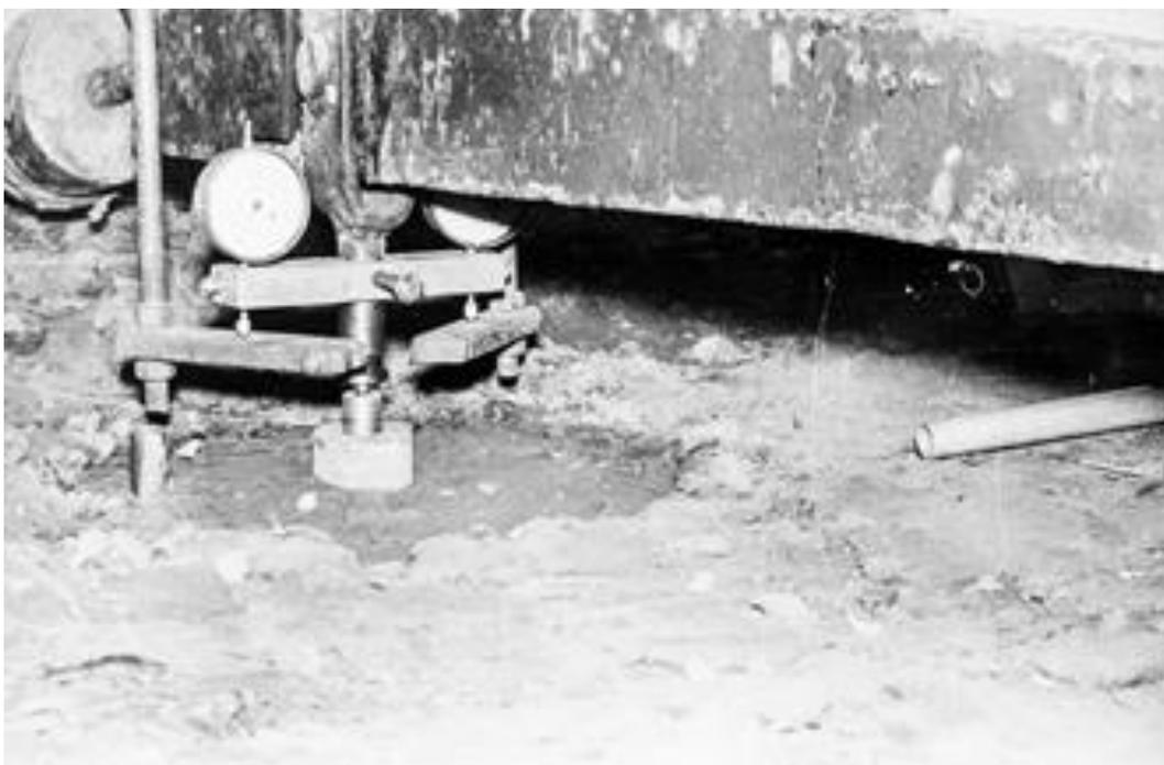
Рис.2 Фрагмент. Испытание бетонной сваики на смерзание с глинистым грунтом в лотке, T= -4 °С.
